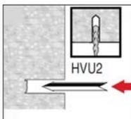
Insérer la capsule chimique avec la pointe vers l'arrière du trou.
